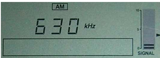
S-Meter senza antenna induttiva
